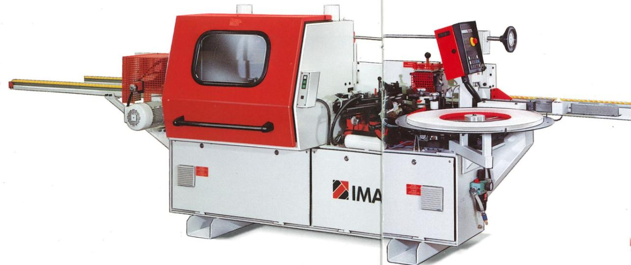
Die Längskantenbearbeitung wird bei beiden QuadroMat-Typen von einem modernen Multifunktionsaggregat durchgeführt. Das Aggregat besitzt einen Motor mit 1,0 kW Leistung, 18000 U/min. Es bearbeitet im Vorlauf zunächst die Oberkante, im Rücklauf dann die Unterkante. Es kann pneumatisch auf 3 Festpositionen gesteuert werden.
