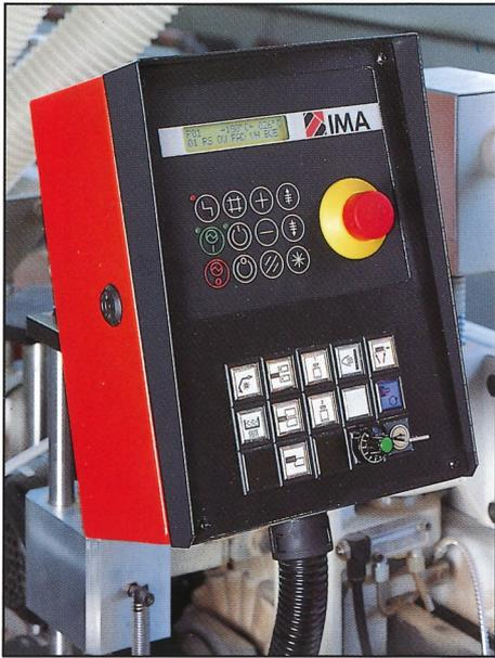
Der QuadroMat ist standardmäßig mit einer speicherprogrammierbaren Steuerung (SPS) versehen. Die Steuerung beinhaltet max. 20 Kantenbearbeitungsprogramme. Alle Funktionen der Maschine können in beliebiger Folge zu einem Programm zusammengestellt werden, z.B.:
