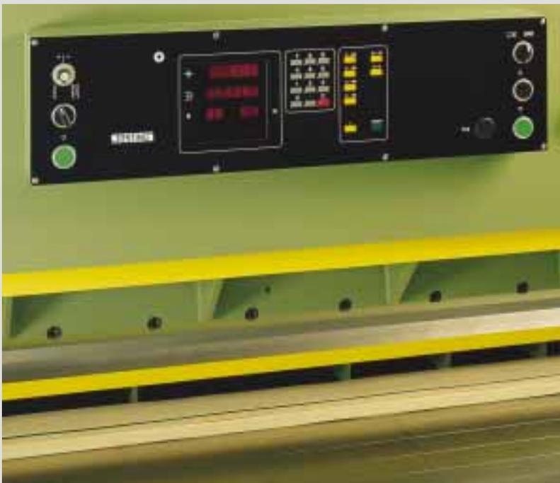
Die Positionier-Steuerung für den Parallelanschlag besitzt eine digitale Breitenmaß-Anzeige, eine Zehnertastatur, einen Schnitzzähler und Tasten zur Vorwahl verschiedener Betriebsarten. Die Einzel- und Teilungsmaße werden nach Betätigung der Starttaste automatisch angefahren. 99 Breitenmaße sind speicherbar. Umschaltung von mm auf inch-Maße ist möglich. Das Schneiden von Furnierstreifen geschieht durch eine schrittweise Verstellung des Parallelanschlages.
