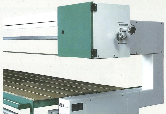
Rechter Maschinenständer mit Kröpfung. Auf dem Tisch können Werkstücke bis ca. 2400 x 850 mm geschliffen werden. Längere Werkstücke können, über die Tischlänge hinaus, durch die Kröpfung geschoben werden. Bandspannung und Bandlaufregulierung mittels Handrad.
