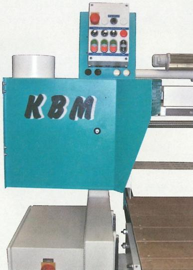
Bedienelemente für Band- und Bürstantrieb, Tischhöhenverstellung und Beleuchtung. Die Maschine ist auf Wunsch mit stufenlosem Bandantrieb und weiterem Zubehör, wie Vakuum-Saugspanneinrichtung, pneumatischem Anpressdruck und pneumatischer Bandspannung lieferbar. Der Frequenzumformer ist in einem separaten Schaltschrank eingebaut. Absaugstutzen senkrecht.
