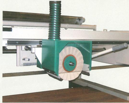
Bürst-/Polieraggregat, Anpressdruck und Vorschub manuell. Ohne Oszillation. Das Zusatzaggregat ist auf Wunsch auch mit stufenloser Drehzahl lieferbar. Es besteht die Möglichkeit der Nachrüstung auf vorhandene Maschinen von KBM und Johannsen. Details diesbezüglich müssen abgeklärt werden.
