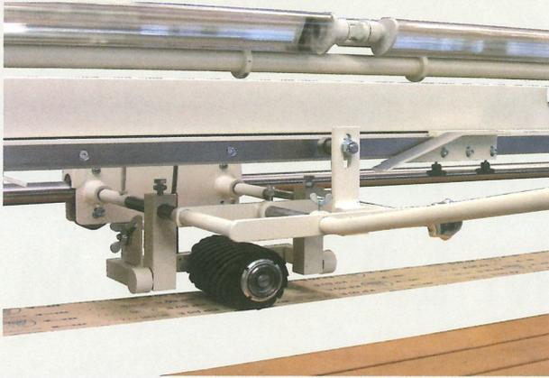
Kontaktrollen-Schleifaggregat mit Hartgummi-Kontaktrolle, pendelnd in einer Wippe aufgehängt. Durch die zusätzliche Laufrolle am Aggregat und den beiden verstellbaren Auf-laufschrägen lässt sich der Punkt, an dem die Kontaktrolle an den Werkstückkanten abheben soll, einstellen. Dies ist eine wesentliche Erleichterung für den Bediener der Maschine.
