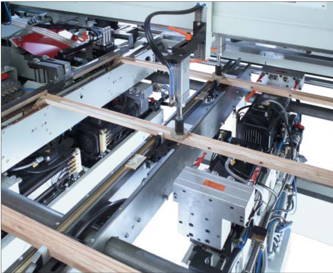
BD/SBD doppelseitige Längsbohrereinheit in 2 Arbeitsstationen
