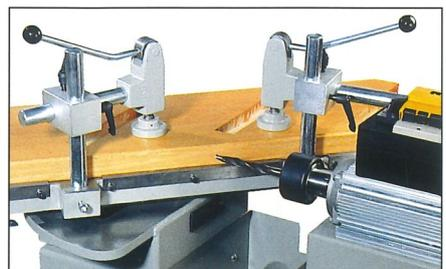
L2S beidseitig bis 60° schwenkbar, Maßskalen für Schwenkbereich.
