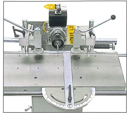
Der große Bohrtisch bietet eine gute Werkstückauflage. Vorteilhaft ist auch die abnehmbare Anschlagleiste am Bohrtisch. Der Gehrungsanschlag ist beidseitig bis 60° schrägstellbar. Innerhalb des Tischbereiches kann er nach der Maßkala im Bohrtisch als Längenspannanschlag eingesetzt werden.
