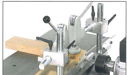
Mit dem KÖLLE-Rahmenanschlagssystem fertigen Sie schnell und problemlos präzise Rahmenverbindungen. Bei einer Teilung von 32 mm beträgt der größte Dübelabstand 192 mm.
