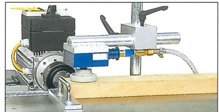
Zum Bohren von größeren Teile-Serien empfehlen wir die pneumatische Werkstückspannung mit Sicherheitsspannzylinder, Handschiebeventil und Druckluftwartungseinheit.
