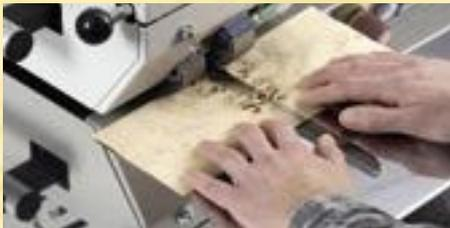
Die vorbeleimten Furniere werden in den Einzug der Maschine eingelegt und ausgerichtet. Durch die Betätigung eines Fußschalters wird der Transport gestartet. Ein sehr feinfühlig arbeitendes Riementransportsystem führt die Furnierstreifen durch eine Heiz- und Druckzone, in welcher der Leim aushärtet und die Furniere fugendicht verklebt werden.
