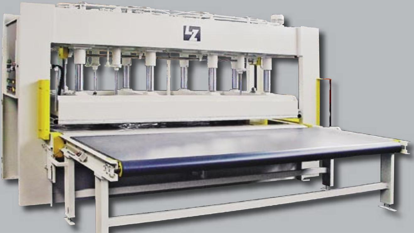
Durchlaufpresse eingebunden als Heiz- und Kühlpresse in der Fertigungs-
