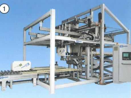
Faltmaschine VKF 20 mit Kartonaustransport sowie Drehvorrichtung um 90° nach links oder rechts
