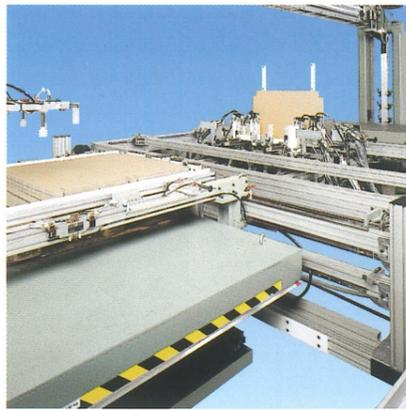
Detailansicht der VKF 10: Kartongenausrichtstation und Faltstation. Das Rüsten der VKF 10 erfolgt motorisch
