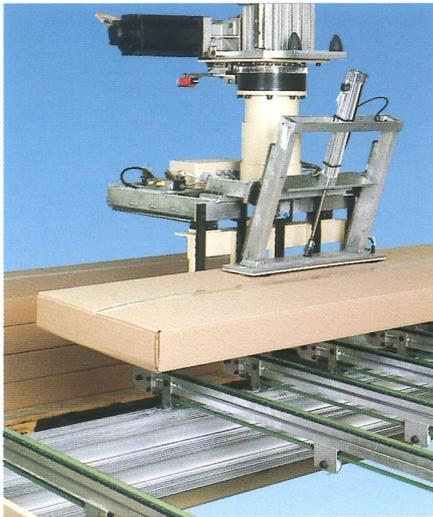
*Paketgreifer am VKA 20 zur Palettierung der Pakete. Mit Hilfe dieses Greifers wird es möglich, Kartons mit verklebtem Mittelverschluss schonend zu palettieren – ohne Gefahr des Wiederaufreißen*
