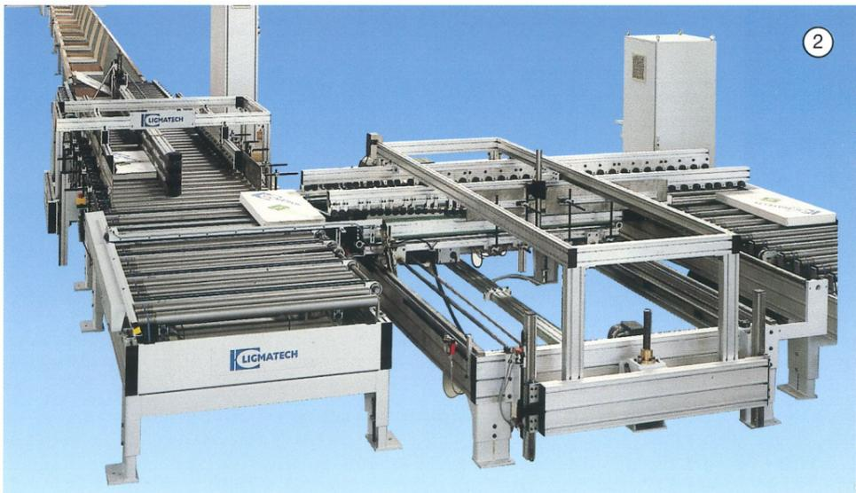
VKV 35 für Querverschluss mit Schmelzkleber sowie vorgeschaltetem doppelseitigem Längverschluss und Packband für Handeinlage auf beiden Seiten im Wechsel: auf der einen Seite einlegen – die andere Seite umrüsten
