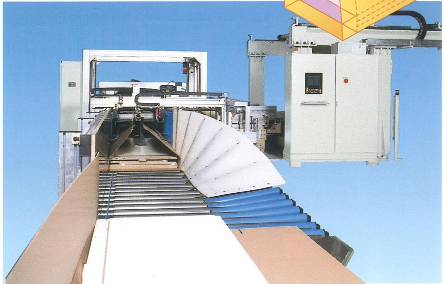
Der Querverschluss erfolgt über eine Winkelstation mit Schmelzkleber. Die Kartons werden anschließend über den Portalstapler VKA 20 mit Greifer palettiert.
