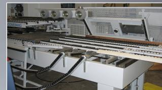
Hübtisch mit Röllchenleisten und abgeklappter Unterstützungsrollenbahn
