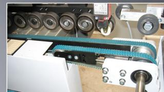
Integration der Rückführstrecke an die Durchlaufmaschine
