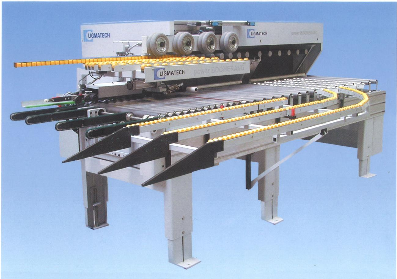
Durch den Einsatz von Linearführungen und elektrischen Kurbeltrieben ist eine größere Dynamik der Anlage möglich. Ein patentiertes Zweitschsystem, das die eigentliche Weiterentwicklung darstellt, ermöglicht eine sprunghafte Erhöhung der Leistungsfähigkeit der Rückführung zum bekannten System.
