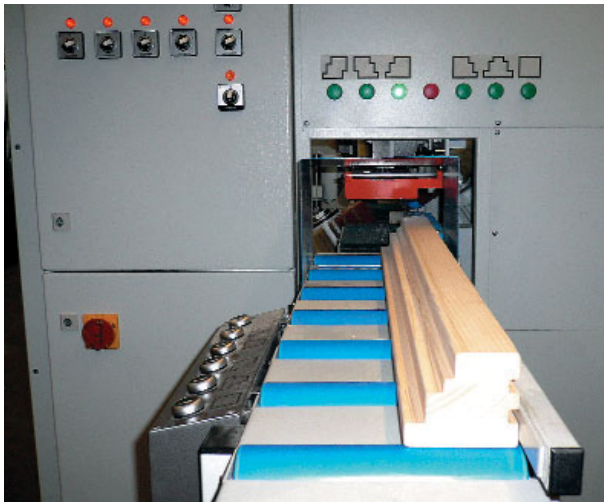
Standardprofilvorbereitung per Taster mit 6 Grundprofilen
