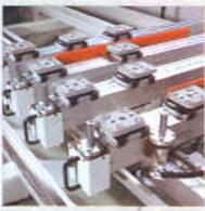
Table de machine 8 barres support avec 2 ventouses, système Schmalz MAKAmove est un centre d'usinage universel à portique mobile travaillant sur 3 ou 4 axes suivant les exigences du client. Il est doté d'une course en Y de 6000 mm.
