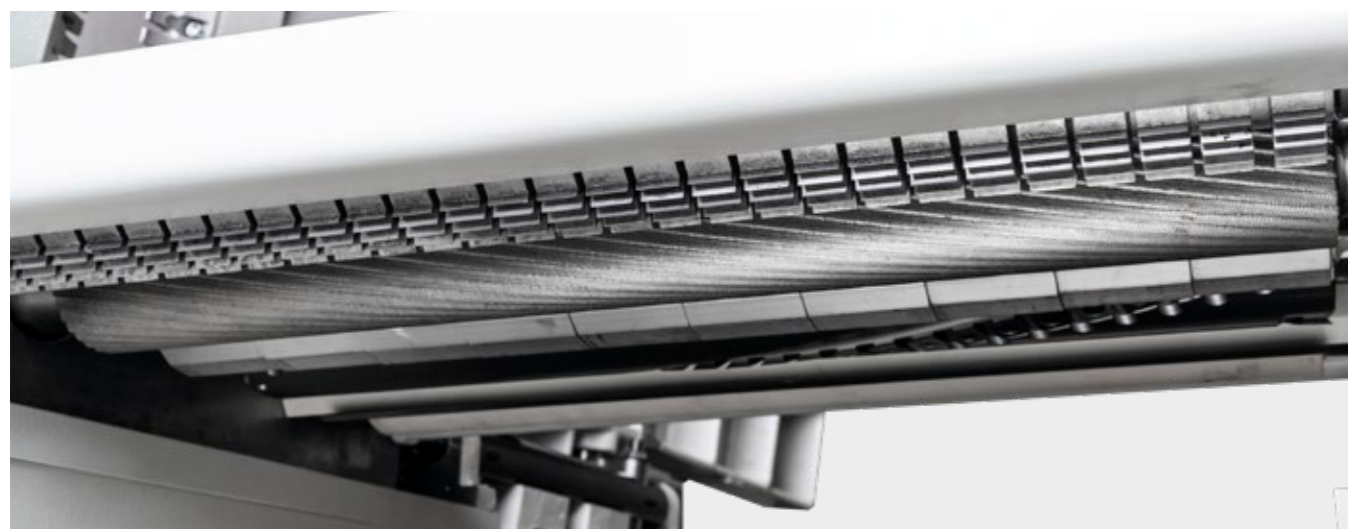
Spiralny wał podający | Standard
