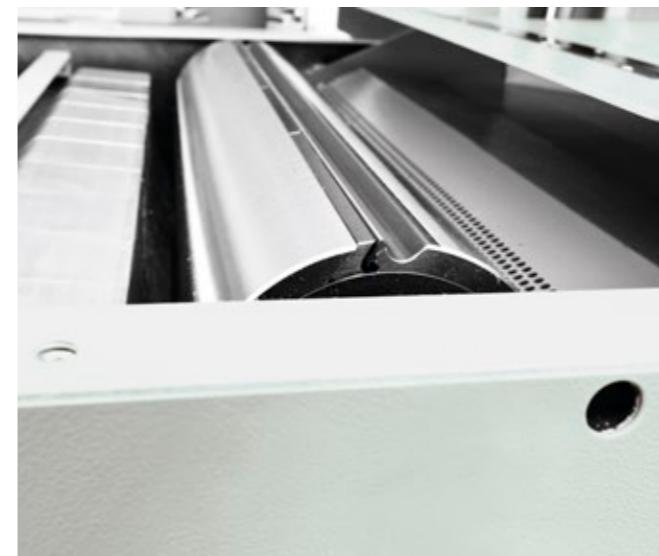
Wał nożowy TERSA | Standard
