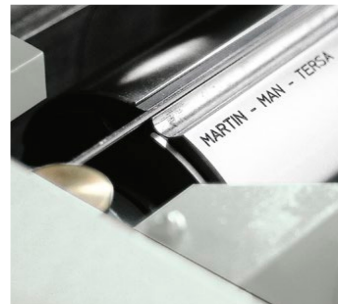
Wał nożowy TERSA | Standard
