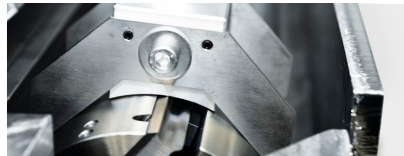
Klinowy wał nożowy z regulatorem | T543
