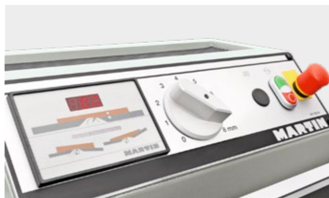
Panel sterowania połączony z ogranicznikiem i przesuwający się wraz z nią | T544
