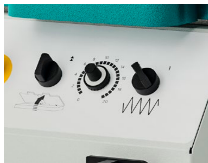
Bezstopniowa regulacja posuwu | T3221
