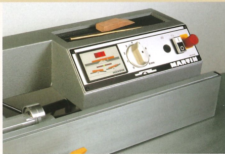
Bedienpult mit fahrendem Abrichtanschlag T544
