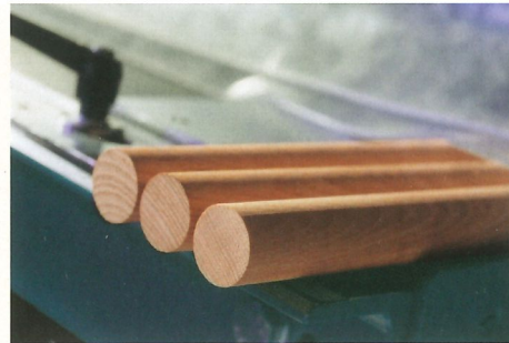
perfekte Rundhölzer in zwei Durchgängen
