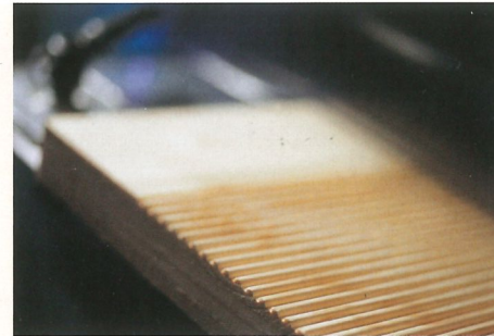
Profilierte Füllungen bis 630 mm Breite
