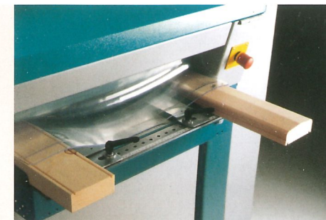
„Hobeln“ unterschiedlicher Profile in einem Durchgang
