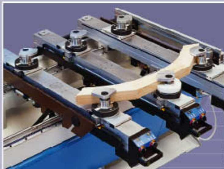
Profilatura interna dell'arco. Profilage intérieur du cintre. Profilieren der Bogen-Innenseite.
