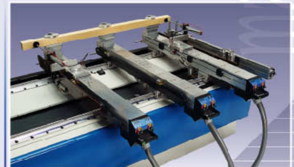
Piazzamento per anubatura montanti per porte o finestre. Positionnement pour pose de fiches sur les montants des portes ou des fenêtres. Positionierung für das Eindrehen von Anuba-Beschlägen bei Türen- oder Fensterrahmen.
