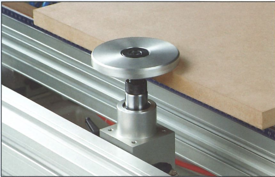
Battuta e bloccaggio con piattello (opt.). Reference stops with clamping device with plates (opt.). Anschlag mit Spannteller (opt.).
