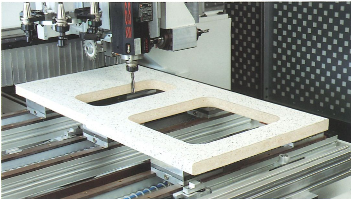
Lavorazione top per cucine. Machining of kitchen work tops. Bearbeitung von Küchenarbeitsplatten.
