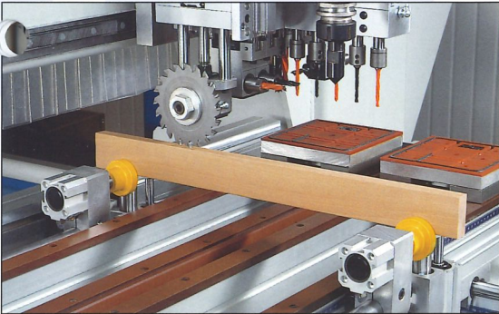
Bloccaggio pezzi stretti (opt.). Narrow pieces clamping device (opt.). Schmalteilstanovorrichtung (opt.).
