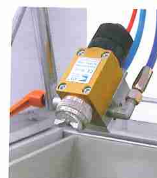
Set Pistole AIRMIX, alimentate da pompa alta pressione OPT. Set of AIRMIX guns fed by high pressure pump (OPT) Juego de pistolas AIRMIX alimentadas por una bomba de alta presión (OPT)
