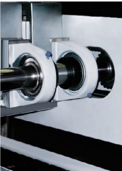
Materialschieber mit AC-Servoantrieb mit unabhängigem Messsystem für höchste Genauigkeit unter härtesten Bedingungen.
