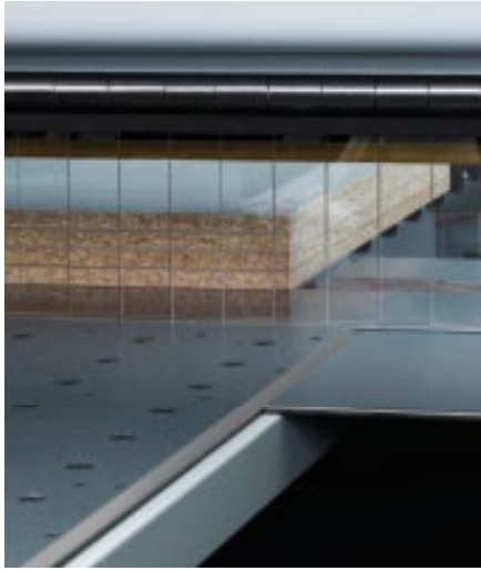
Stabiler Druckbalken aus Stahl mit variabler Öffnungshöhe.
