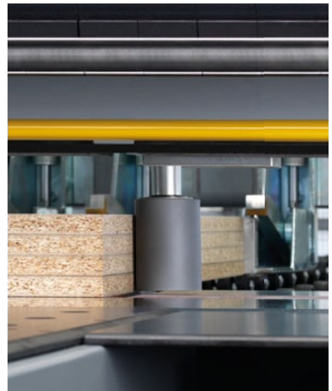
Doppel-Winkel-Andrückvorrichtung – kompromisslos präzises Anlegen am Winkelanschlag.
