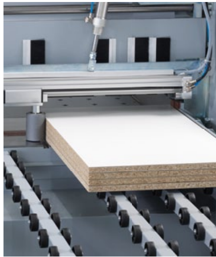
Winkel-Andrückvorrichtung für eine schonende und präzise Ausrichtung der Platten.
