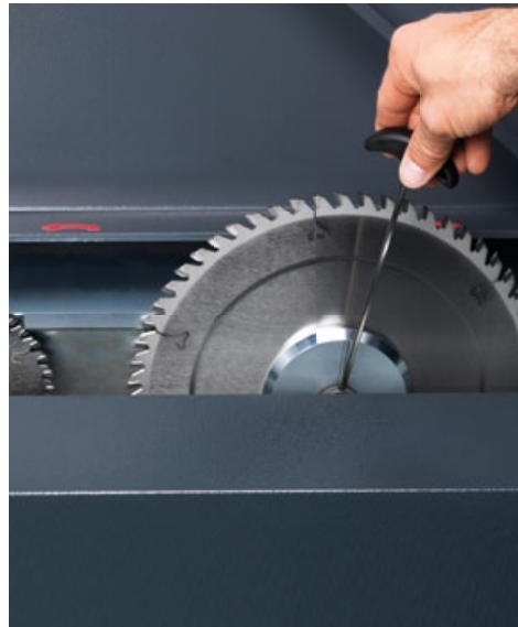
Das ProLock® EasyFix Sägeblatt-Schnellwechsel garantiert kürzeste Rüstzeiten.
