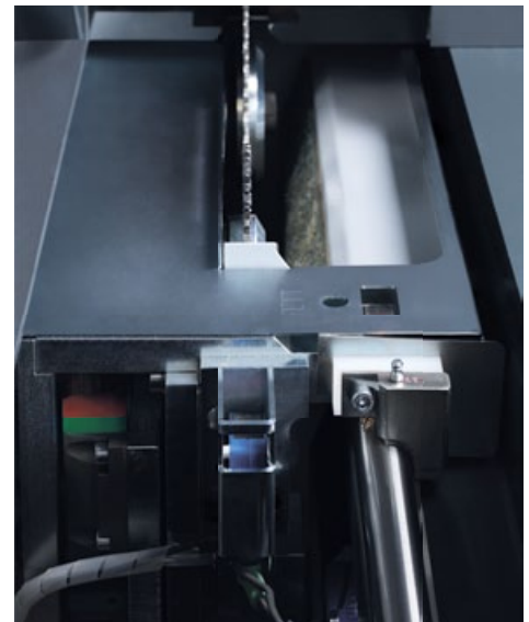
Die Sägewagenführung auf Rundwellen ermöglicht höhere Vorschubgeschwindigkeiten.
