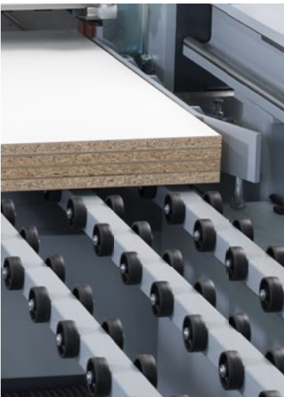
Rollenbahnen am hinteren Auflagetisch für einfaches Plattenhandling zur Schnittlinie.
