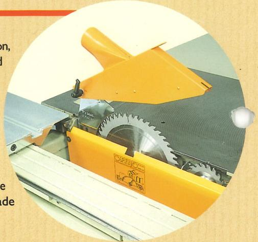
Der Sägeblattschutz ist am Spaltkeil befestigt und mit integriertem Absaugstutzen ausgestattet; das Sägeblatt wird durch einen Mikroschalter überwacht, welcher den sicheren Zugang zum Sägeaggregat garantiert.
