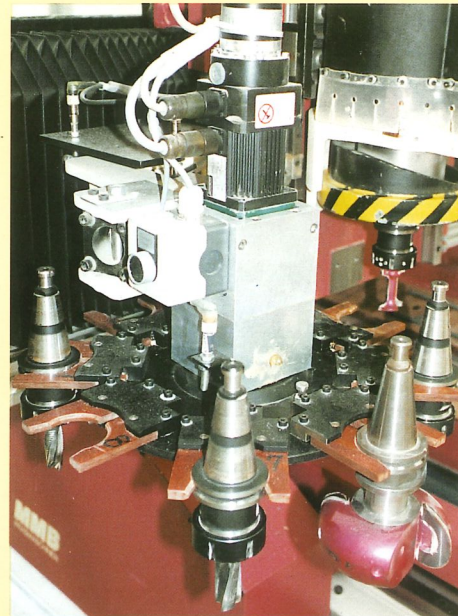
Tellerwerkzeugwechsler mit 8 Ablegeplätzen.
