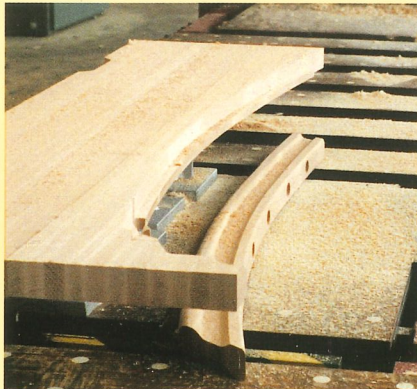
Handlaufbearbeitung an der Unterseite des Wangenholzes. Komplettbearbeitung von Wange und Handlauf.
