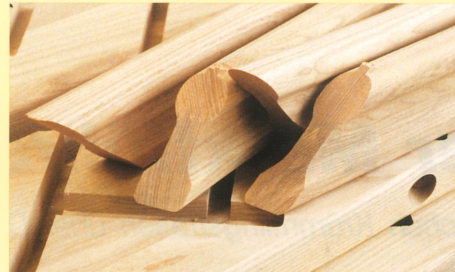
Griffriellenprofile nur mit CFA 4-5 möglich.
