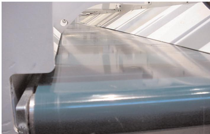
Tutti gli sfridi cadono verso il basso, e favoriti dalla particolare forma del telaio che facilita l'operazione di raccolta, vengono convogliati all'esterno da un nastro trasportatore, lasciando così la macchina sempre libera e pulita, pronta per effettuare veloci cambi di lavorazione in qualsiasi momento.
