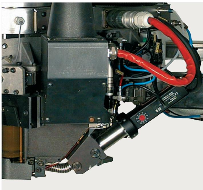
I rulli di pressione **gestiti dal controllo numerico** assicurano, nelle varie fasi di bordatura, la corretta pressione per un perfetto incollaggio del bordo anche su angoli e profili complessi.
