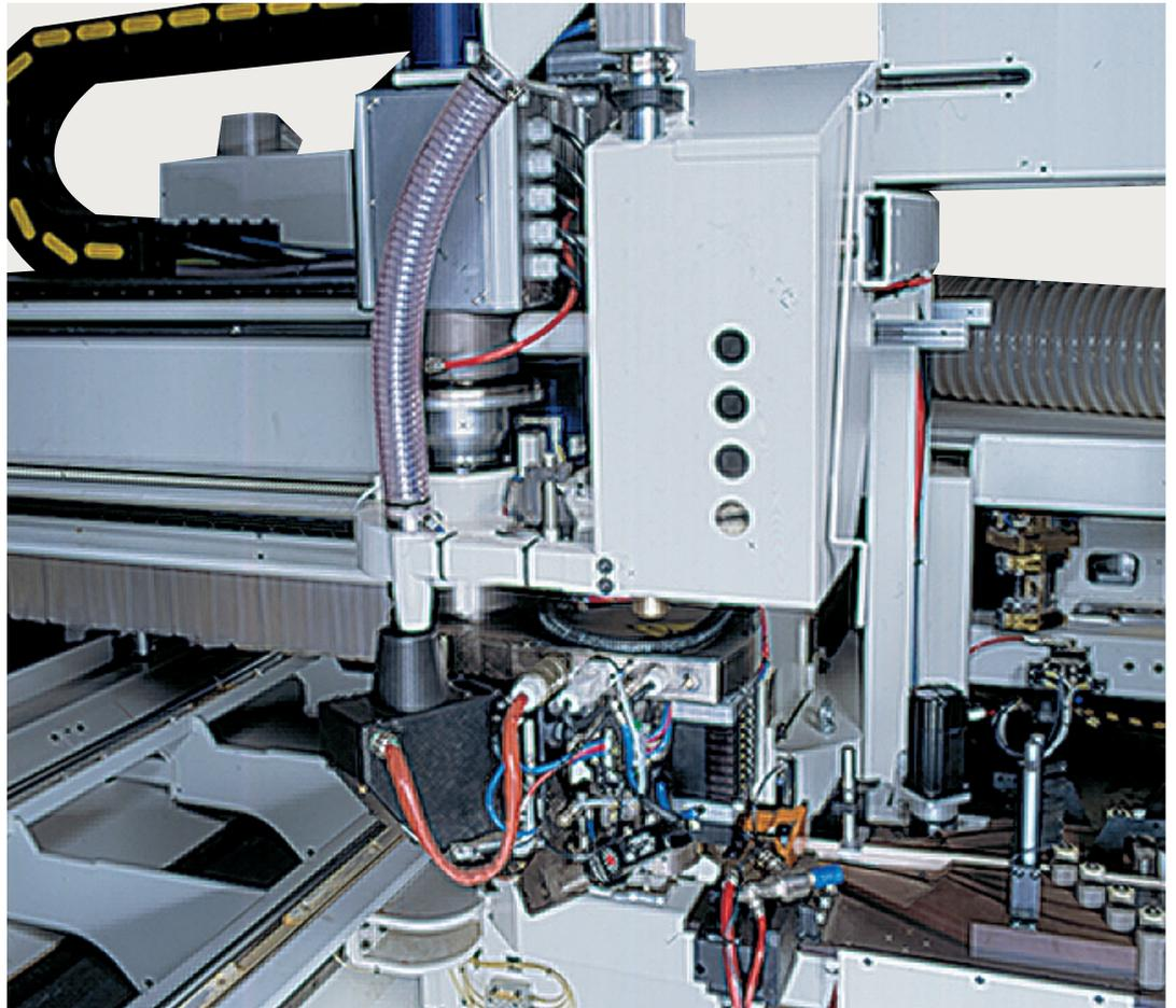
Il magazzino bordi, solidale al gruppo mobile, è in grado di ospitare fino a 6 bordi differenti, per poter **cambiare rapidamente tipo di bordo in base alla lavorazione impostata**. La selezione, l'alimentazione e il controllo della quantità residua del bordo sono totalmente gestite dal controllo numerico.
