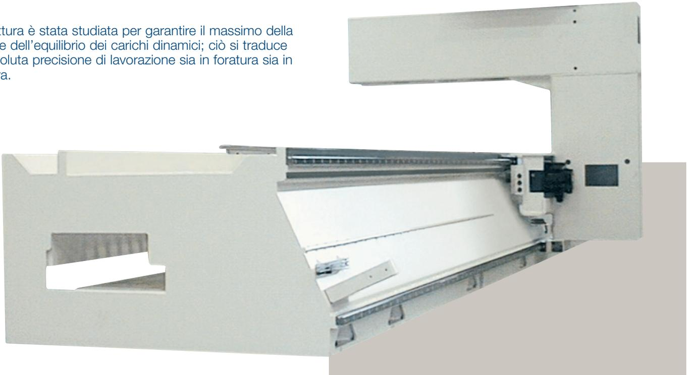
Il basamento autoportante in acciaio con sezione triangolare costituisce un **solido e bilanciato supporto** per le parti in movimento della macchina. Le nervature e l'ampia base di appoggio sono state progettate e realizzate per assicurare stabilità alla macchina e precisione nel tempo, in ogni condizione di lavoro.
