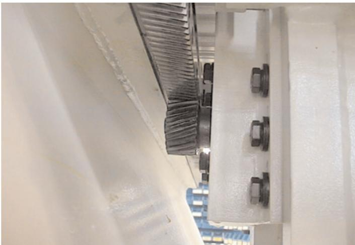
La movimentazione degli assi avviene tramite motori Brushless, su viti a ricircolo di sfere e cremagliere con recupero automatico dei giochi; in questo modo sono possibili **accelerazioni e decelerazioni fino a 5 m/sec<sup>2</sup>** e assoluta precisione di posizionamento. Non richiede particolare manutenzione potendo essere lubrificata automaticamente senza interventi da parte dell'operatore.
