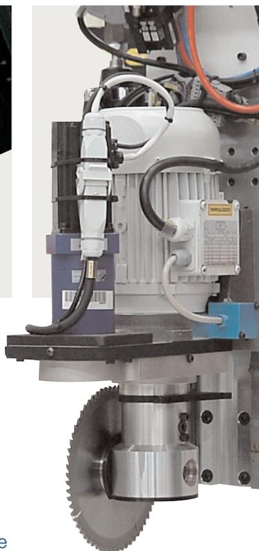
Gruppo fresa a disco fisso o con rotazione automatica 0/90° e 0/360° gestita dal controllo numerico per lame diametro 160/200 mm.
