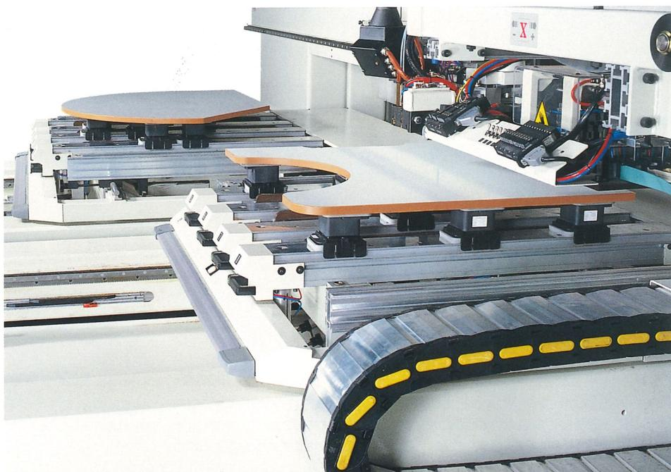
Der Antrieb mit den beiden an den Seiten jedes Tisches montierten Zahnstangen ist die Garantie für Stabilität und Widerstandskraft bei **Beschleunigungen bis zu 1G**.
