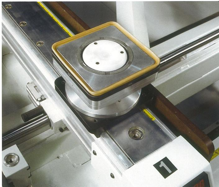
Eine in den Saugern integrierte Positionierhilfe mit grodimensionierten werkstckschonenden Auflageflachen ermglicht ein bequemes Positionieren der Werkstcke. Verglichen mit anderen Lsungen bietet dieses System ein Maximum an Flexibilitat auch bei komplexen Werkstcken. Auerdem wird die Werkstckbestckung beschleunigt, da der Bediener nicht die Saugerpositionen messen mu.
