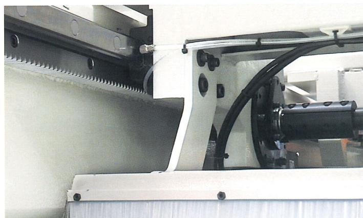
Die stabilen 30mm - Prismenführungen und der Zahnstangenantrieb werden auch zur Bewegung von Bohr/Fräsguppen und der Verleimteils verwendet. Die Beschleunigung bis zu 1G und die Rampengeschwindigkeit bis zu 150 m/min dieser Gruppen erlauben eine beträchtliche Verringerung der Bearbeitungszeit der Werkstücke.
