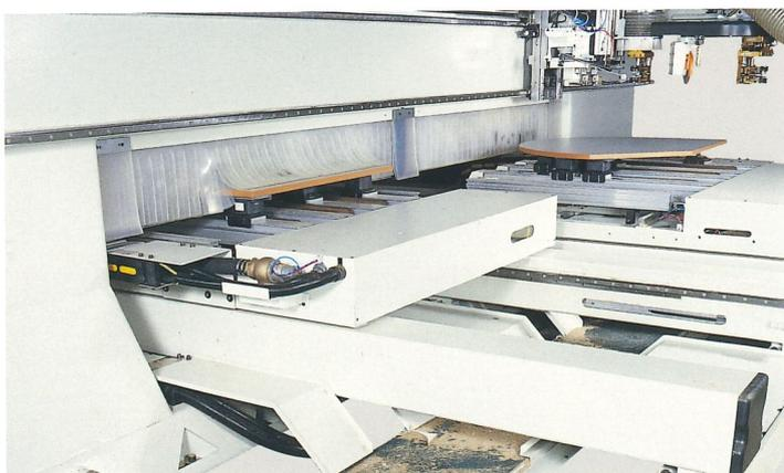
Die voneinander unabhängigen Tische laufen in Y-Richtung auf zwei Prismenführungen mit einem doppelten Zahnstangensystem, das jeweils an den Tischaußenseiten liegt. Dieses System ermöglicht ein perfektes Kräftegleichgewicht und eine perfekte Bewegung in der Y-Achse.
