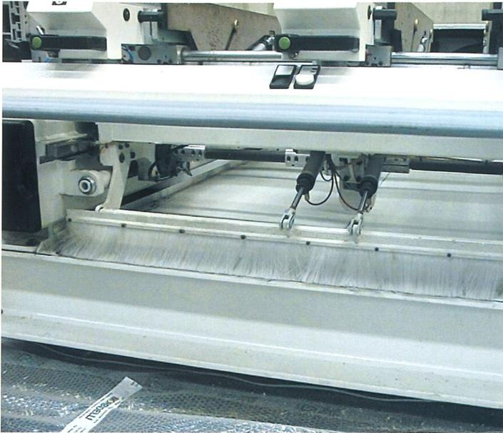
Ein Bürstensystem unter dem Tisch reinigt die Maschine von Reststücken und Spänen und leitet diese zum hinteren Maschinenbereich.
