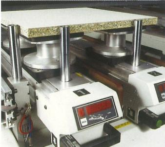
Vordere und seitliche pneumatische Bezugsanschlage aus Stahl, die automatisch vom Programm gesteuert werden. Die Anschlage sind mit Sensoren ausgestattet, die ein korrektes Absenken der Anschlage berwachen.
