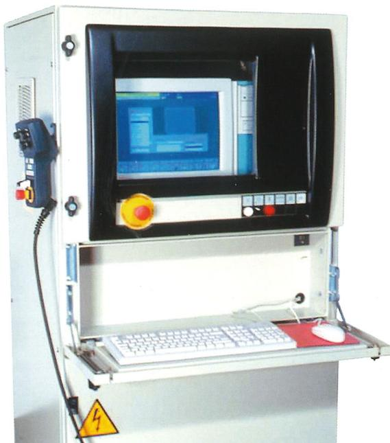
Die CNC-Steuerung erlaubt es, alle Produktionsphasen der Maschine **Einfach** zu steuern. Dies dank einer Hardware, die aus einem PC und eine **einfachen und intuitiven** Softwareschnittstelle besteht.
