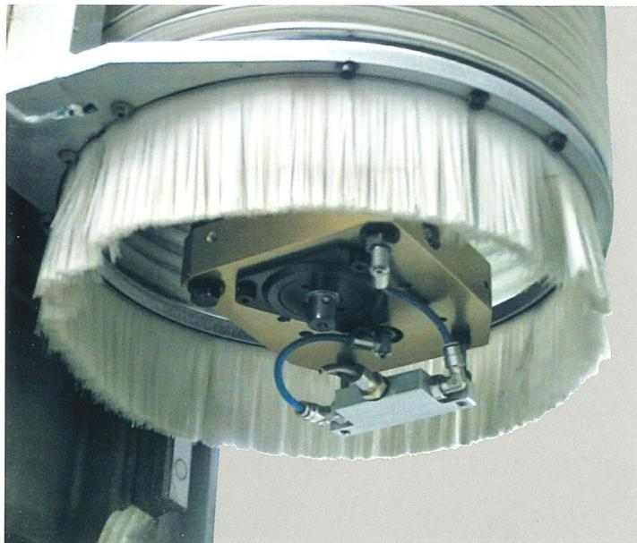
Das Absaugsystem der Frässpindel besteht aus einer **CNC-gesteuerten Absaughaube**, die auf das Werkstück reicht und das Absaugen der Späne nach oben hin erleichtert. Das Absaugsystem des Bohrregagats ist dagegen mit einem bürstenlosen System ausgestattet, das die Späne an dem Punkt absaugt, an dem gearbeitet wird.
