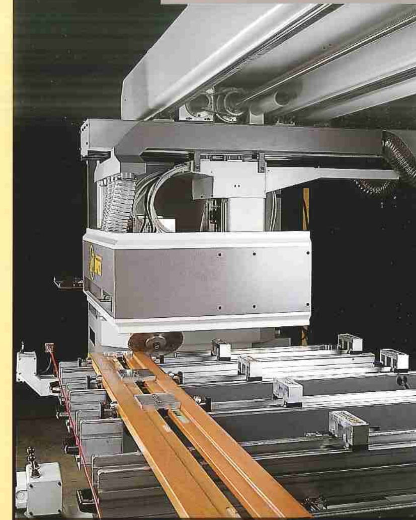
*Vista del sistema de fijación fijo para el mecanizado de los cercos o marcos de las puertas de la máquina. *View of the fixed clamping system for the machined of the frames of the doors or the doorcases in the machine.
