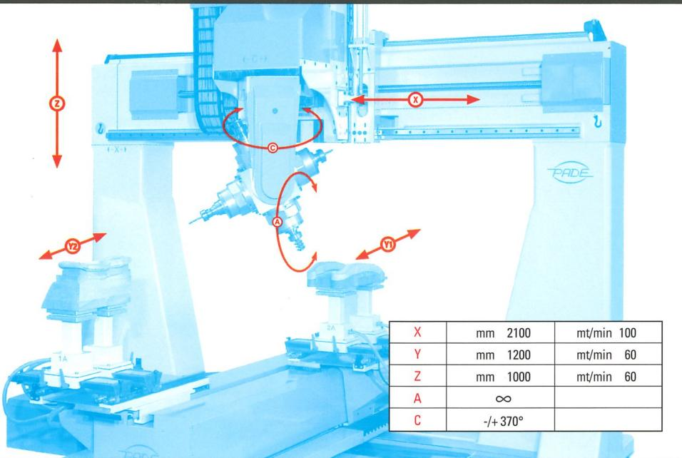
La struttura a portale permette la lavorazione delle 5 facce del pezzo in un unico posizionamento. La testa di lavoro è composta da 4 elettromandrini indipendenti in linea, con cuscinetti ceramici e grande velocità di cambio dell'utensile in lavorazione grazie al sistema a revolver. È inoltre possibile equipaggiare la macchina con cambio utensili automatico.
