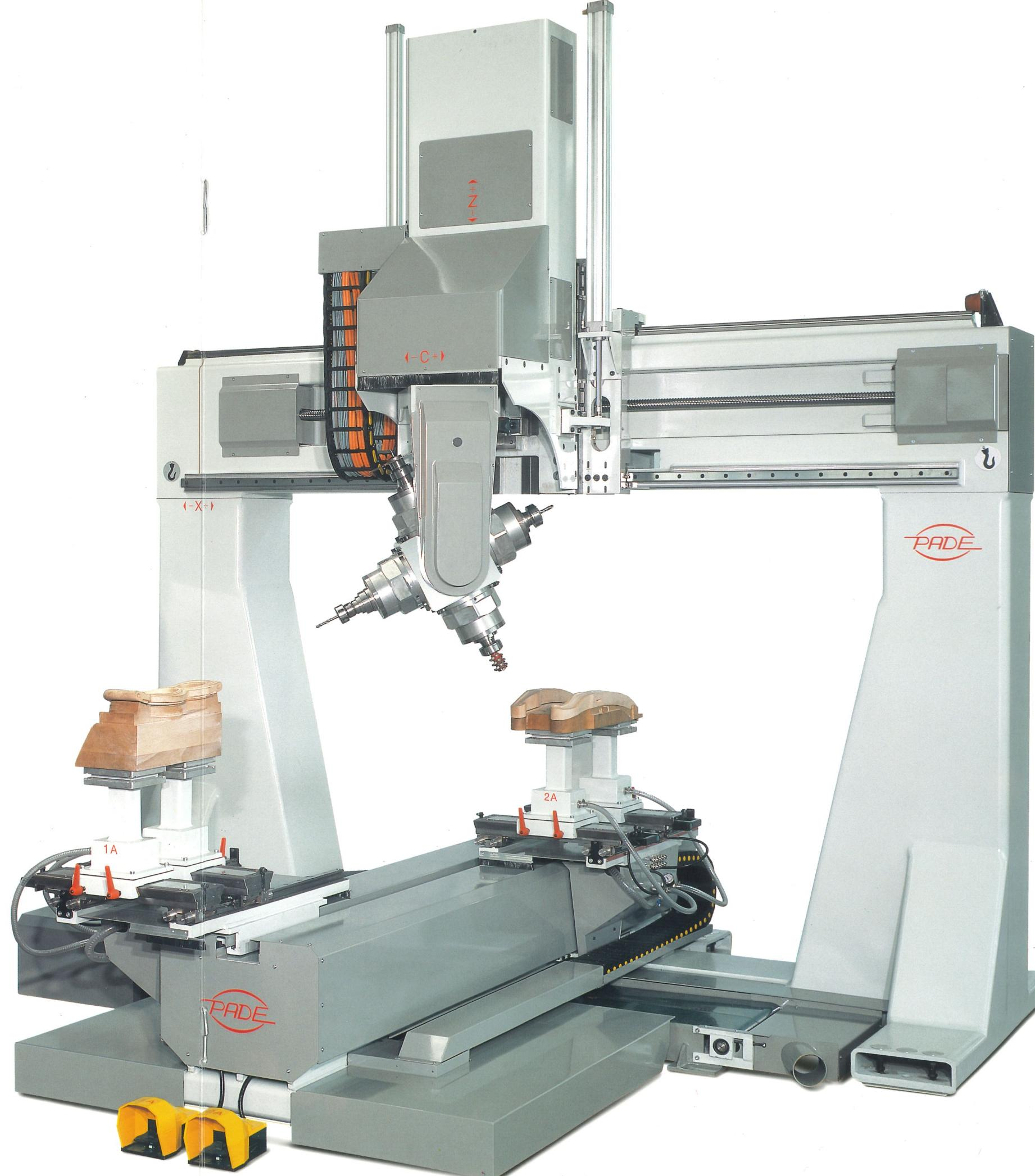
Il controllo numerico è fornito completo di tutte le opzioni software per permettere alla macchina di lavorare i pezzi più complessi su 5 assi simultanei. Personal computer integrato per poter sfruttare il potente software applicativo PADEASY che lavora con s.o. Windows. Di grande facilità permette ad un operatore privo di qualsiasi conoscenza informatica di poter programmare autonomamente le operazioni base, quali fori, cave e tenoni sin dal 1° giorno di installazione della macchina.
