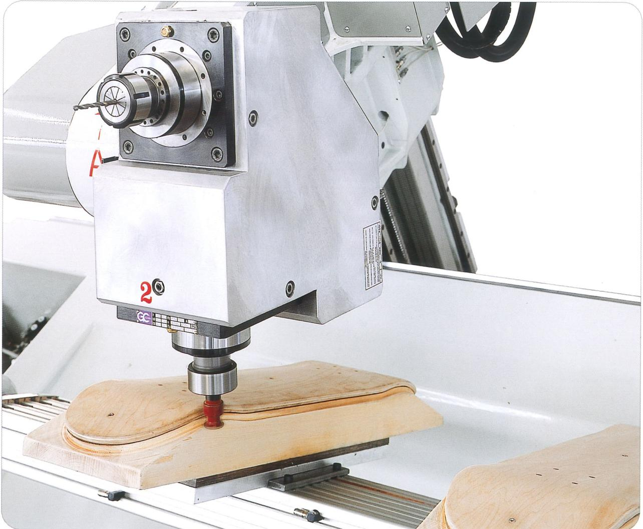
**S**wing est le centre multifonctions pour les usinages complexes à haute vitesse sur les bois massifs particuliers, plastique et dérivés. Il permet l'usinage des 6 faces d'une pièce en un unique positionnement! La possibilité d'être équipé de 2 magasins porte-pièces offre des avantages uniques :
