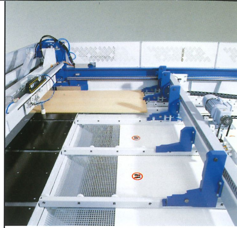
Anschlagpositionierung selbstüberwachend, CNC gesteuert
