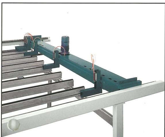
**Lo spintore, con o senza pinze,** comandato da inverter, scorre su guide cilindriche con ruote sagomate e piane autoallineanti. Le pinze molto robuste bloccano il pacco di pannelli da sezionare, assicurando un taglio molto preciso.
