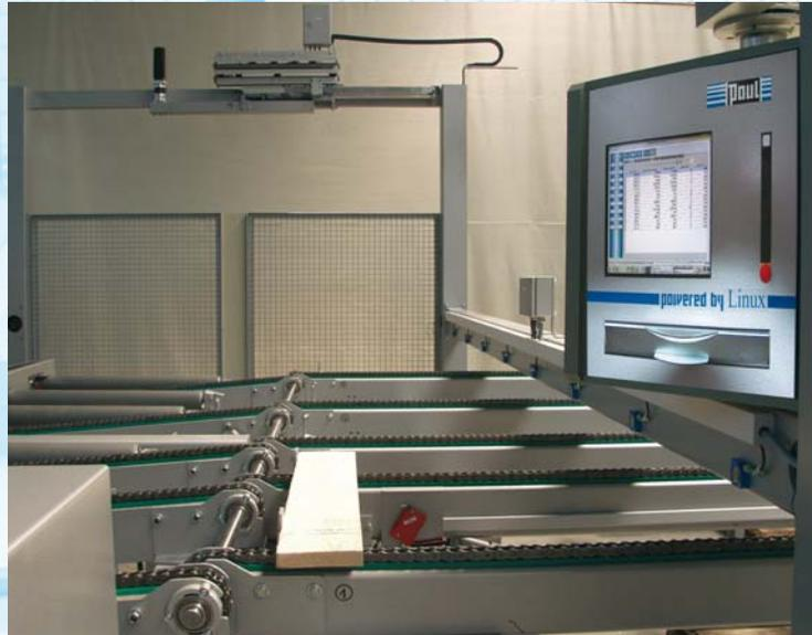
Abb. 8: Das Laserportal wird mittels eines servogesteuerten Motors positioniert. Die Laser sind leicht verstellbar, um die Sägeaufspannung klar widerzuspiegeln.
