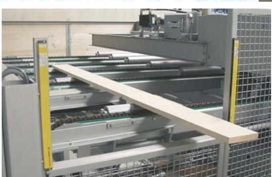
Entnahme nicht geeigneter Werkstücke
