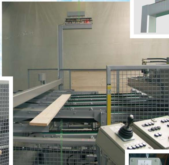
Bedienpult mit Joystickfunktion
