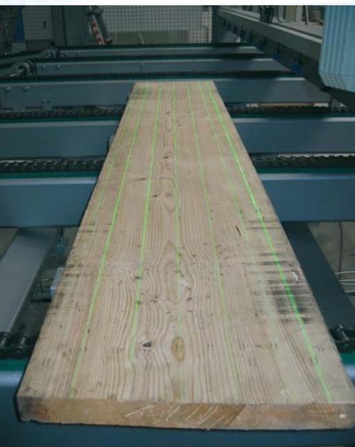
Abb. 3: Die Lasersensoren vermessen das Werkstück
