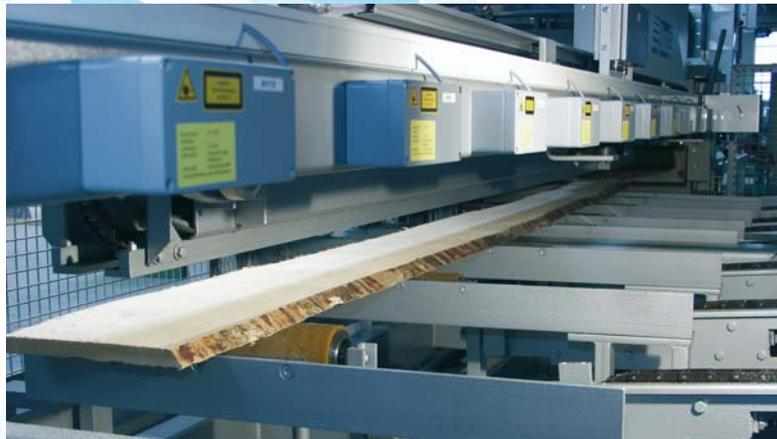
Abb. 2: Der Verschiebetisch positioniert das Werkstück sehr genau
