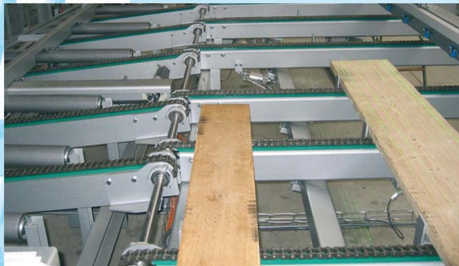
Abb. 10: Die Anschlagsschiene geht in Position, damit das Brett rechtwinklig und genau auf der vom Bediener ausgewählten Schnittlösung basierend der Auftrennsäge zugeführt werden kann.
