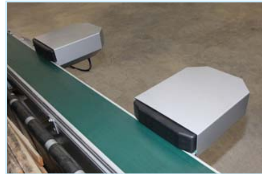
Abb. 12 Abschiebestationen mit Vollverkleidung für hohe Sicherheit
