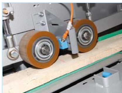
Abb. 9 Separate Messstation erkennt die Positionen der Kreidemarkierungen
