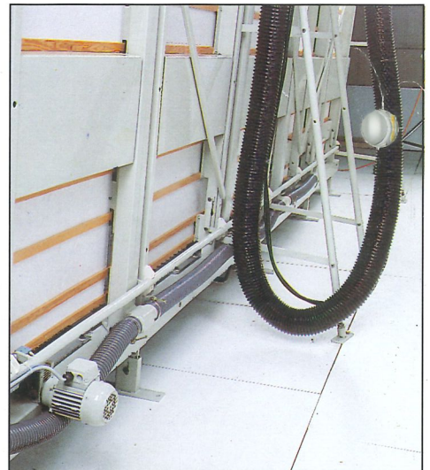
Motorino spostamento piano. - Motor for shifting frame. - Motor fuer Wegschwenkrost. - Motor para el deslizamiento del marco. - Moteur pour le chassis escamotable.
