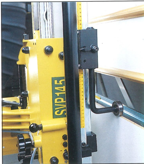
Dispositivo taglio a strisce orizzontali (optional). - Repeat cutting device of horizontal strips. (optional). - Waagrechter Streifenanschlag. (Auf Wunsch). - Corte tiras horizontales (optional). - Dispositif pour coupes horizontales répétitives (optional).
