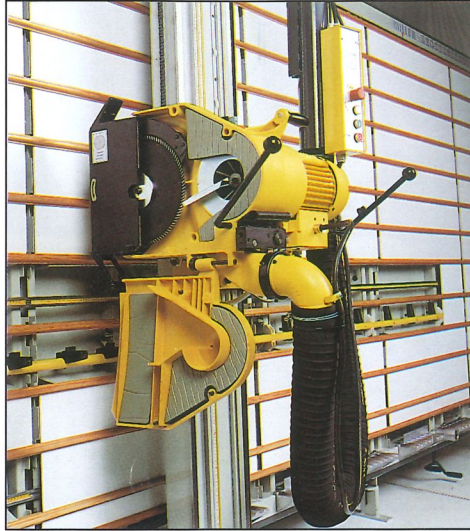
Carter coprilama aperto con insonorizzazione. Opening of blade cover with soundproof system. - Offener Sägeschutz mit Schalldämmung. - Tapa porta-hoja abierta con sistema de insonorización. - Unité de sciage ouverte avec système d'insonorisation.
