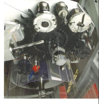
Die Aggregatebewegungen verlaufen innerhalb des gekapselten Portals, wobei die Werkzeuge alle Vorschubbewegungen ausführen. Der mitfahrende, automatische Werkzeugwechsler mit 15 Werkzeugplätzen und einem maximalen Flugkreis von 300 mm gewährleistet den Einsatz größerer Werkzeuge und handelsüblicher Zusatzköpfe.
