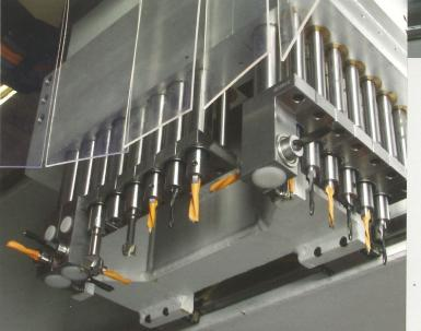
Zur Auswahl der Aggregate steht neben der Grundausführung mit einer Frässpindel, eine Werkzeugschnittstelle HSK 63-F sowie ein Mehrfachbohraggregat mit 15 einzeln vorlegbaren Spindeln zur Verfügung. Die Leistungsaufnahme der Spindel wird beim Einsatz einer wassergekühlten Frässpindel permanent überwacht und somit vor Schäden geschützt.
