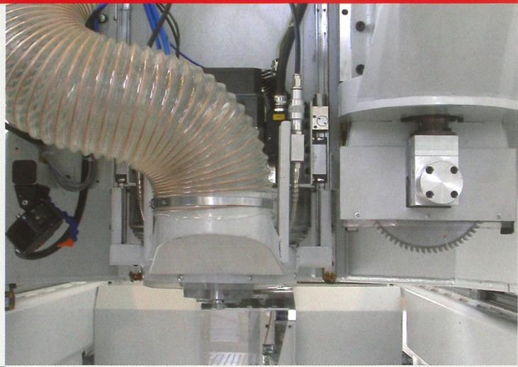
Das Mehrspindelbohraggregat ist mit 30 einzeln ansteuerbaren Bohrspindeln für Lochreihen- und Konstruktionsbohrungen in L-Form angeordnet. Es kann den Arbeitstisch komplett umfahren und ist mit einer eigenen Vorlegeeinheit in Z-Richtung vor dem Vertikalaggregat angeordnet.
