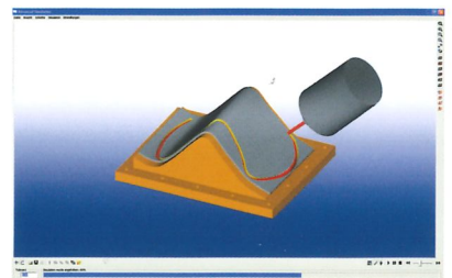
In AlphaCAM programmiertes 5-achsiges Besäumen mit der Werkzeugflanke
