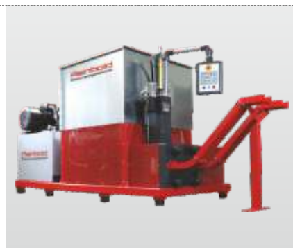
Baureihe RB 400 RS: zur industriellen Herstellung von eckigen Briketts
