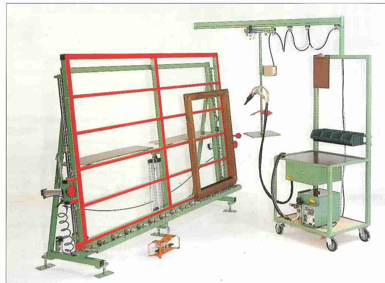
Montagetisch RU-S2 mit Filzleisten, Beistellwagen RU-WAL mit Ausleger für Geräteaufhänger
