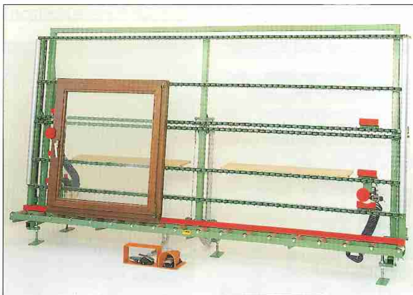
Montagetisch RU-S2 Anlagefläche mit Desmopanrollen und Flachspannzylinder
