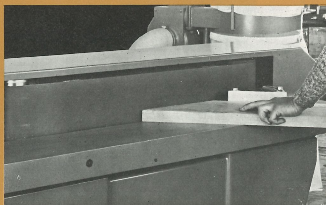
Levigatura bordo con impiego di squadretta graduata Edge sanding with mitre gauge Ponçage du bord au guide d'onglet Schleifen von Kanten mit Hilfe des Gehrungsanschlages.
