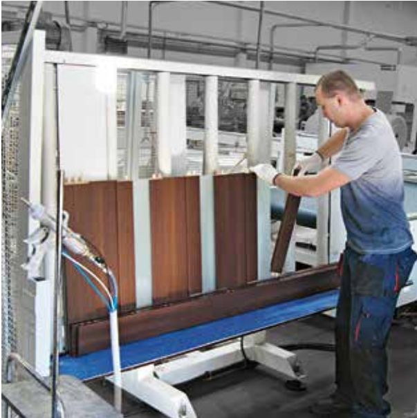
Fertigungslinie für Innentüren mit der action h Korpuspresse
