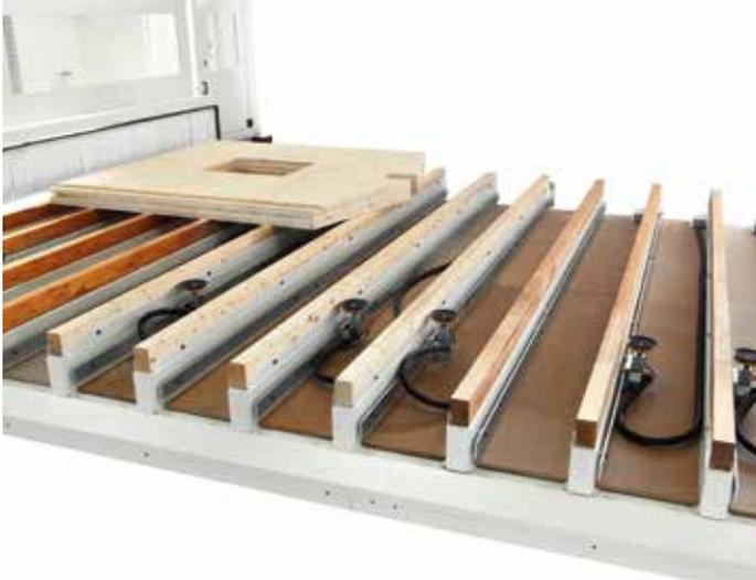
Das Design der Maschine stützt sich auf ein modulares System, das die Abmessungen des Arbeitstisches bis zu 50 m anpassen kann, um alle Produktionsanforderungen erfüllen zu können.
