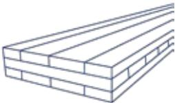
BSP-Platten zur Herstellung von Wänden und Decken von Wohnhäusern und mehrstöckigen Gebäuden.
