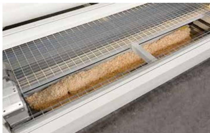
Die **Reinigungssysteme gewährleisten das automatische Entfernen von Spänen, die sich im Raum unter und an den Seiten des Arbeitstisches ansammeln.**
