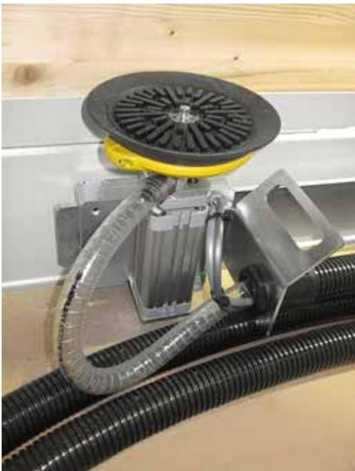
Auch kleine Werkstücke können auf dem Arbeitstisch durch das Absaugsystem gehalten werden.
