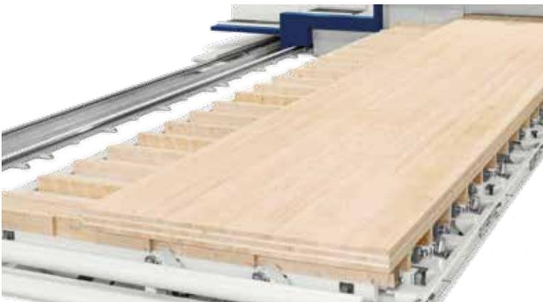
Auf dem vielseitig konfigurierbaren Arbeitstisch sind die **Handhabung, Positionierung und Spannung der Platten mit einem Gewicht bis zu 12.700 kg vollautomatisch** möglich.
