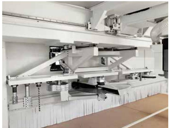
Das **Werkzeugmagazin mit bis zu 12 Plätzen** ist so konzipiert, dass alle Werkzeuge an Bord sind, die für die Durchführung der Bearbeitungsvorgänge erforderlich sind.
