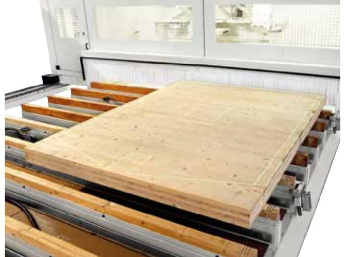
Um die Positionierung von großen und schweren Elementen zu erleichtern, kann ein Laserhilfe-System konfiguriert werden.
