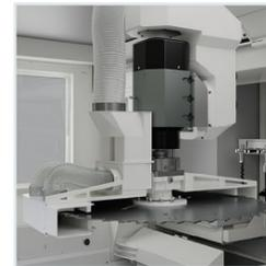
Das leistungsstarke und leistungsfähige Arbeitsaggregat 30 kW ermöglicht **große Zerspanung in staubfreiem Zustand,** dank dem spezial-Absaugsystem.
