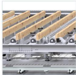
**Schneller und reibungsloser Arbeitsablauf** dank motorisierter Hochleistungsrollen für eine Handlingsgeschwindigkeit von bis zu 40 m/min und durch Systeme zur automatischen Werkstückreferenzierung.
