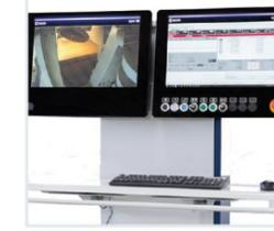
**Vollständige Prozessüberwachung,** dank dem Videoüberwachungssystem mit 4 hochauflösenden Kameras zur Kontrolle aller Bearbeitungen (Beschickung, Schnittbearbeitung und Entladung). Die **Doppel-eye-M-Konsole** erleichtert dem Bediener die Verwaltung und Steuerung der Maschine in Echtzeit. Das System umfasst auch eine "Videorekorder"-Funktion.
