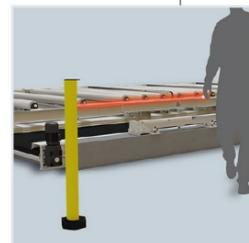
**Zugang zum Arbeitsbereich in absoluter Sicherheit,** dank der Verwendung von Laserschranken am Perimeter, sowohl in eigenständiger Konfiguration als auch in der Konfiguration mit automatischem Arbeitstisch.
