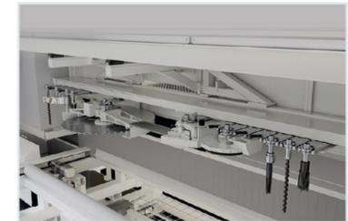
**Einfache Werkzeugbestückung** dank 15 Stationen für Standardwerkzeuge (Fräser und Bohrer) und Spezialaggregate (Sägeblatt, Kettensäge und Hobel).
