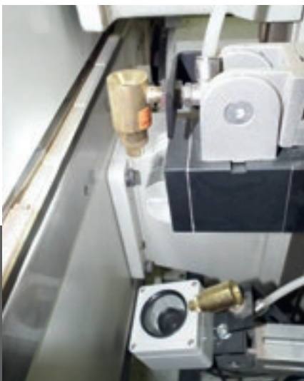
Kontrollsystem der Werkstückabmessungen.
