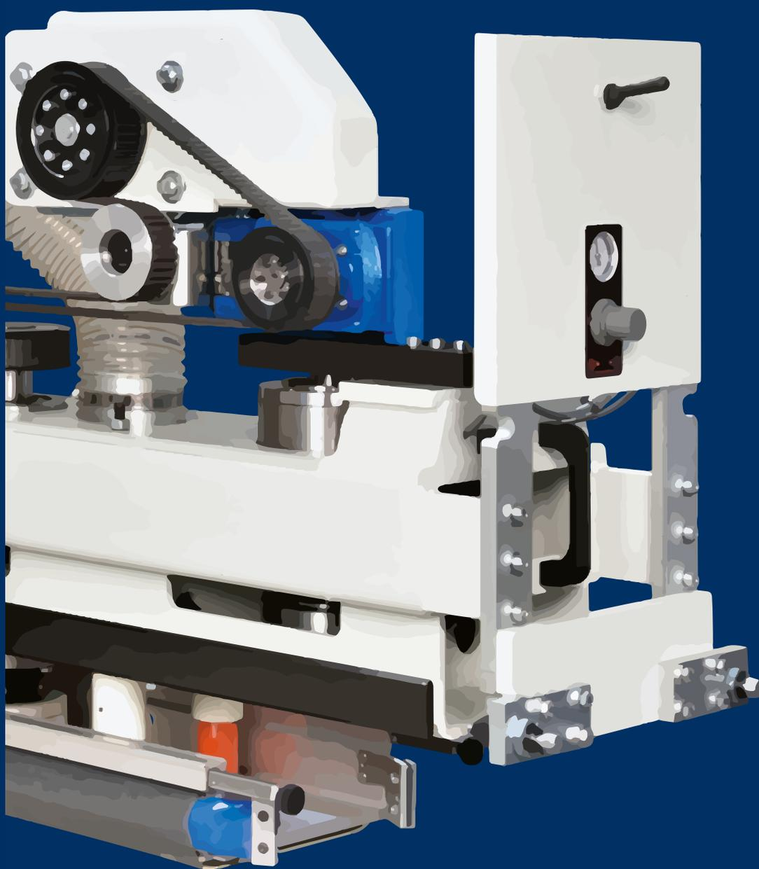
Il pattino orbitante Finesand elimina efficacemente dai traversi le rigature provocate dalla levigatura longitudinale: è la soluzione ideale per la superfinitura dei pezzi sfinestrati (antine da cucina, porte, finestre) o a venatura incrociata.
