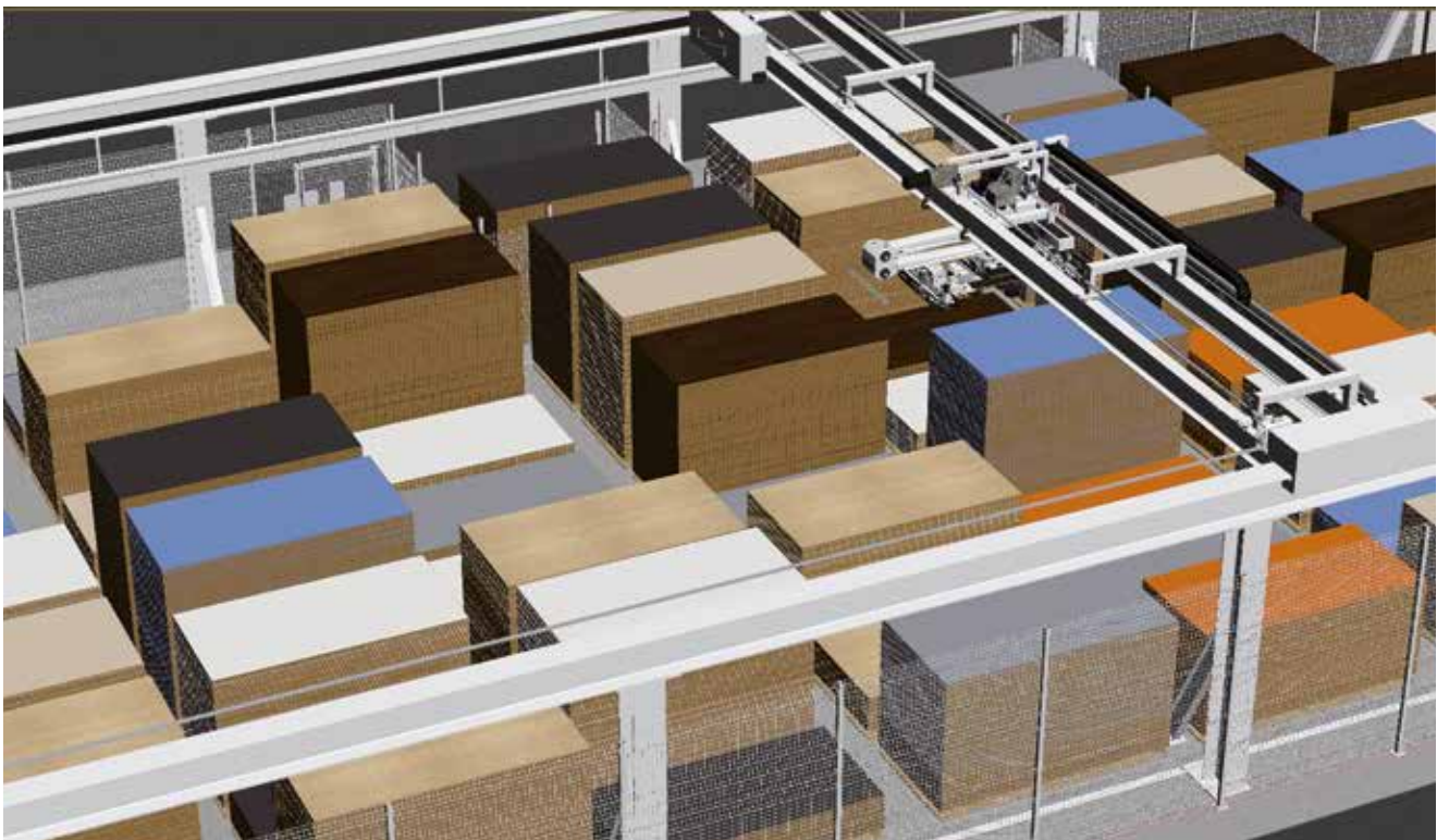
La estructura de acero permite efectuar movimientos sin vibraciones incluso en los almacenes de gran tamaño.
