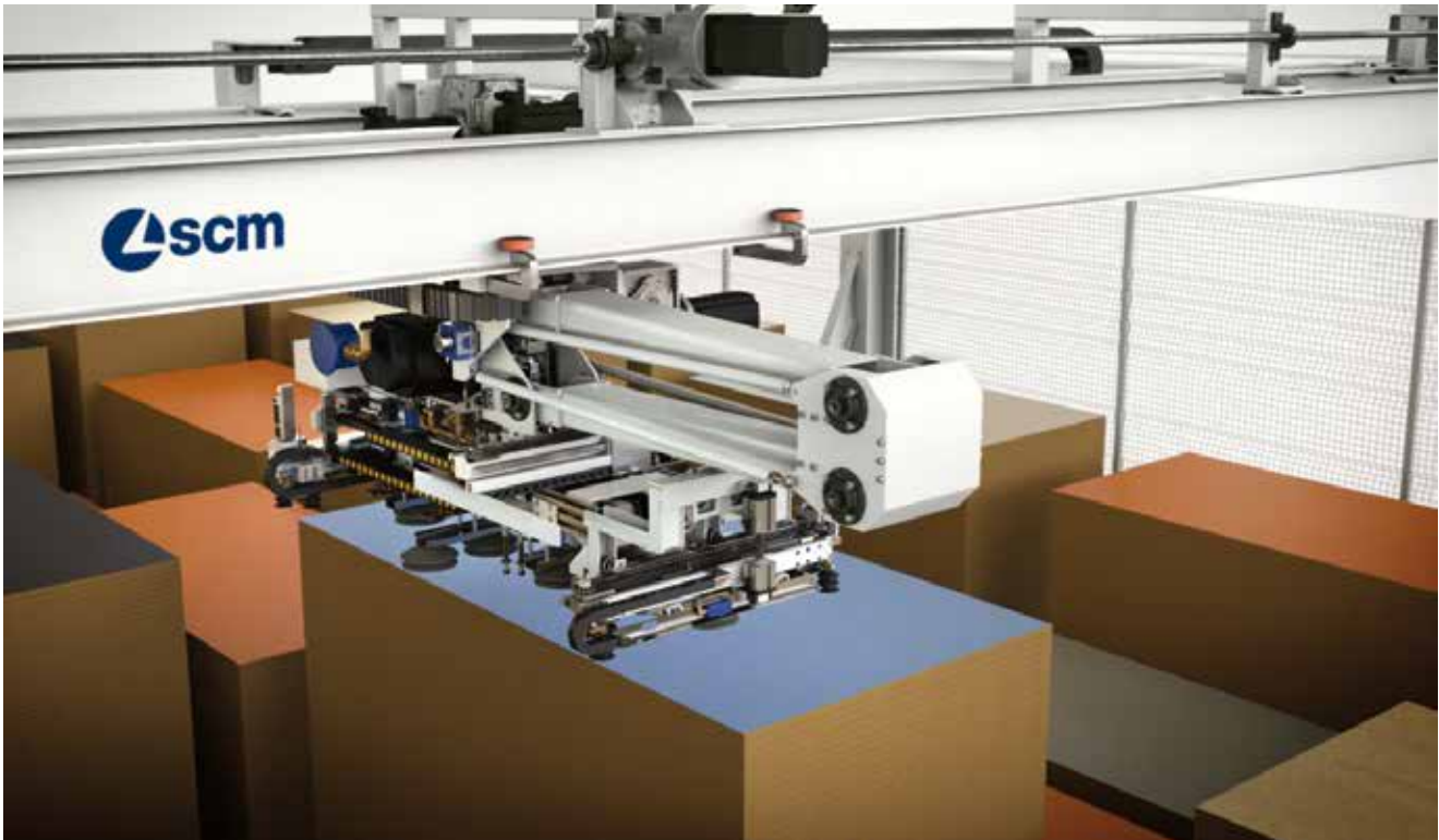
Brazo de ventosas diseñado para integrar los dispositivos de gestión de los tableros delgados .
