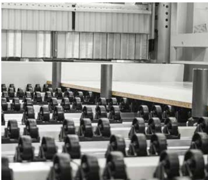
**SEITLICHE MOTORISIERTER AUSRICHTER** auf Prismenführungen mit vorgespannter Kugelumlaufspindel.
