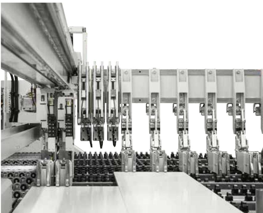
Die hohe Flexibilität der Vorrichtungen wird auch durch die Spannanzgen des Hauptschiebers gewährleistet, vom Arbeitsbereich wegschwenkbar, die die Arretierung von Streifen mit unterschiedlicher Breite und daher die Durchführung beliebiger Schnittarten ohne Laufwegbeschränkungen ermöglichen.
