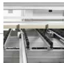
**Seitliche motorisierter Ausrichter für Querschnitte**
