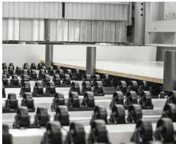
**SEITLICHE MOTORISIERTER AUSRICHTER** auf Prismenführungen mit vorgespannter Kugelumlaufspindel.
