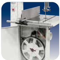
Ausgewuchtete Guß-Laufräder Festigkeit und Robustheit
