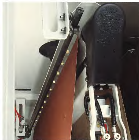
Timed oscillating blowers Zeitgesteuerte oszillierende Abblasvorrichtungen
