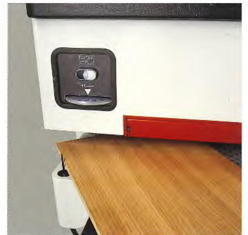
Automatic table positioning Elektronische Einstellung des Arbeitstisches
