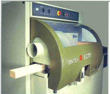
ARBEITSSICHERHEIT UND GERINGE LÄRMENTWICKLUNG: Die serienmässige Ausstattung mit einer leicht zu öffnenden Lärmschutzhaube garantiert hohe Arbeitssicherheit und reduziert den Geräuschpegel. SINTEX verfügt ausserdem über Sicherheitsvorrichtungen, die den strengsten internationalen Vorschriften entsprechen.
