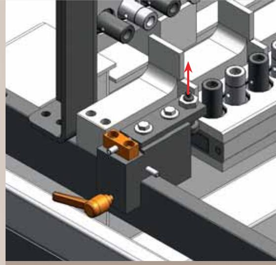
File di fori allineate perfettamente ▶ con l'utilizzo del pin per la ripresa delle forature (opz.)
