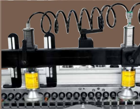
Giunzioni perfettamente allineate grazie alle battute di profondità e pistoni di bloccaggio pezzi
