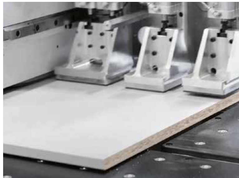
Das Werkstück wird oben und unten gespannt, und am vorderen Anschlag positioniert.
