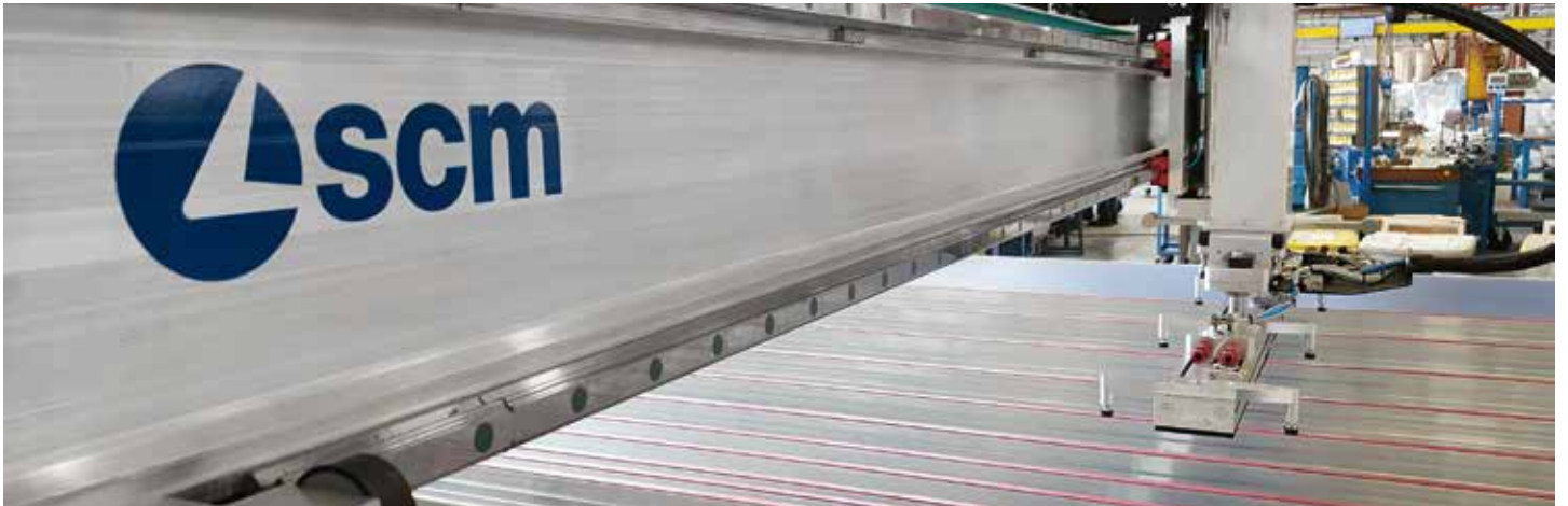
Rückholanlage Pickback mit Portalsystem und schnellen NC Achsen
