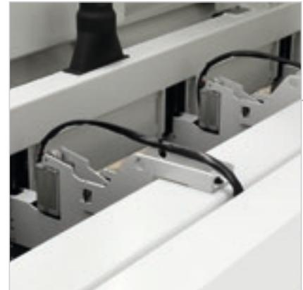
La presión homogénea y controlada en el paquete de paneles que se debe cortar se garantiza mediante el **prensor** con estructura de elemento individual.
