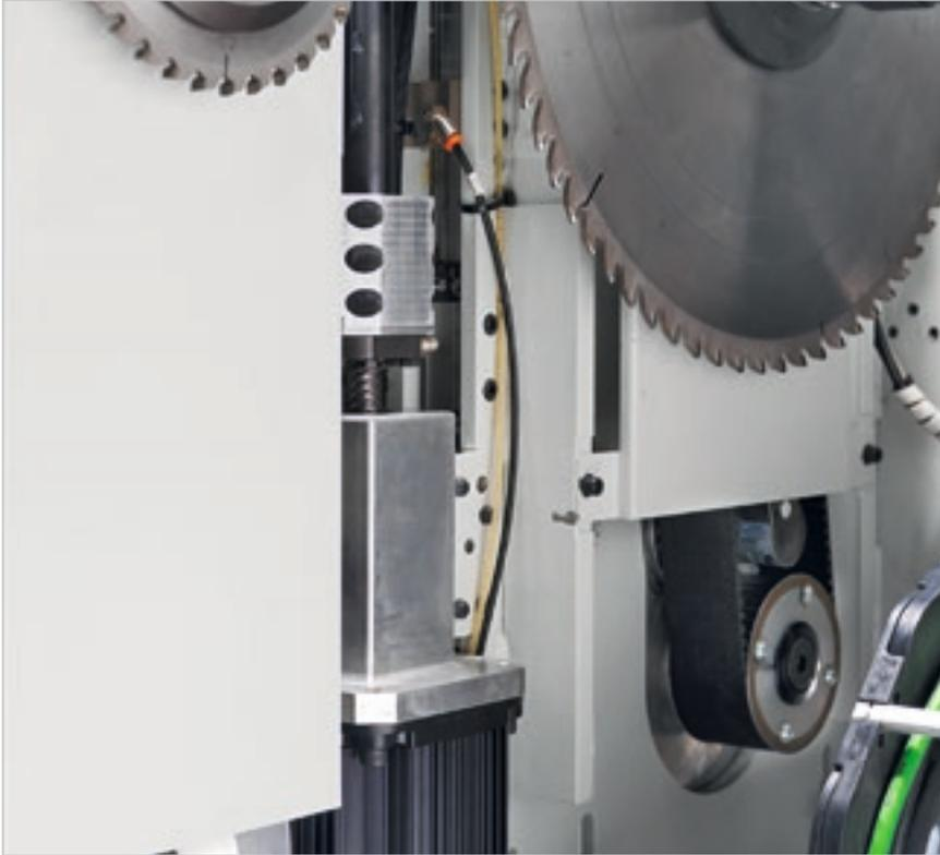
La **subida de las sierras** se gestiona mediante un motor Brushless y un sistema con tornillo de recirculación de bolas. Dicho sistema garantiza una regulación precisa y rápida del saliente de la hoja.
