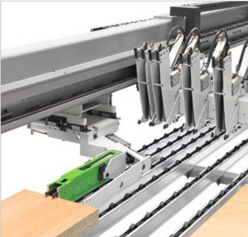
Corte transversal de la última tira con avance de la carga y rotación del paquete de paneles siguiente.
